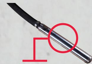
Булава изготовлена из закаленной стали. Снабжена термодатчиками.
